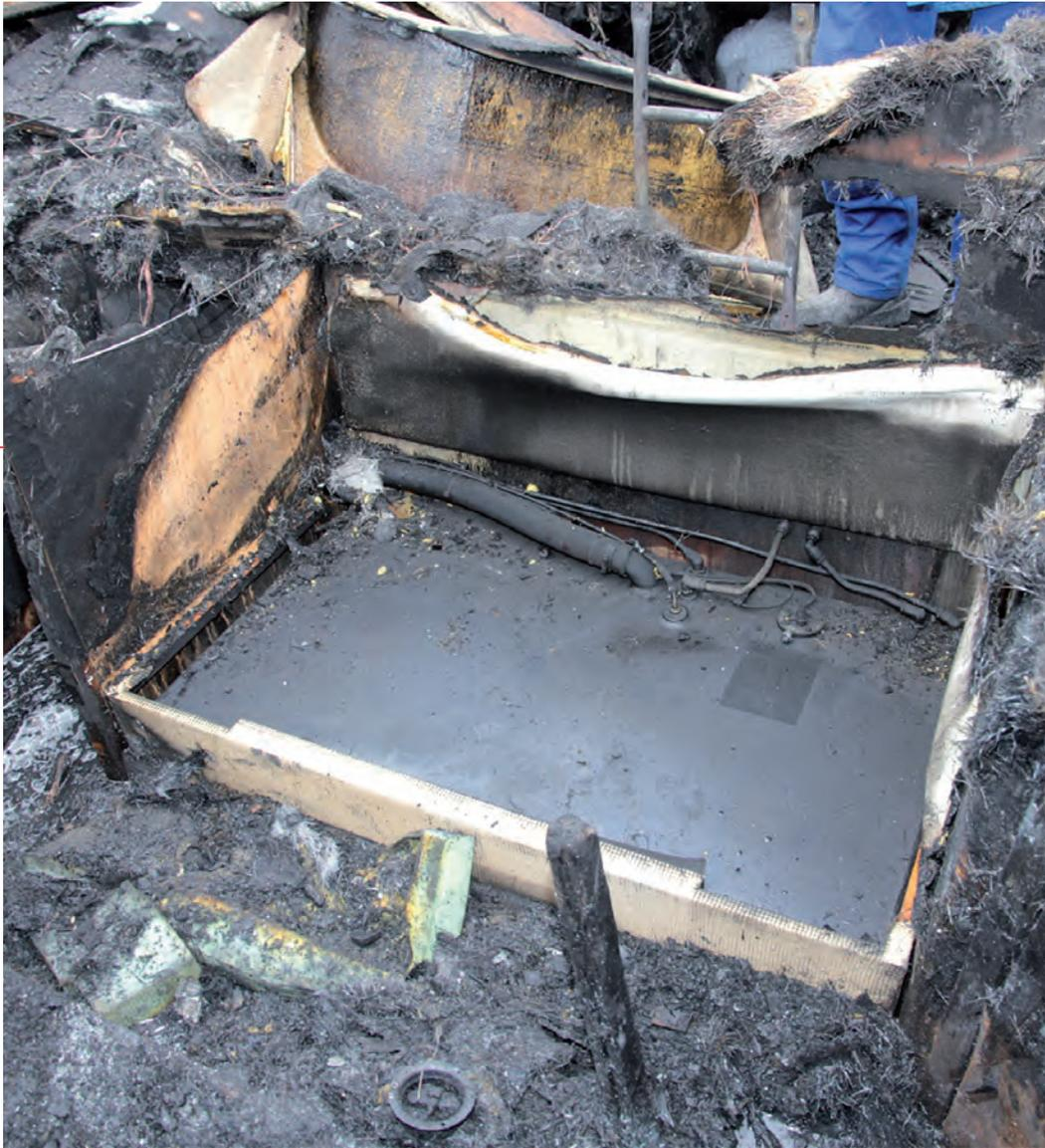
**Bild 3** | Unter der hochgeklappten Sitzbank ist der Tank zu sehen.
