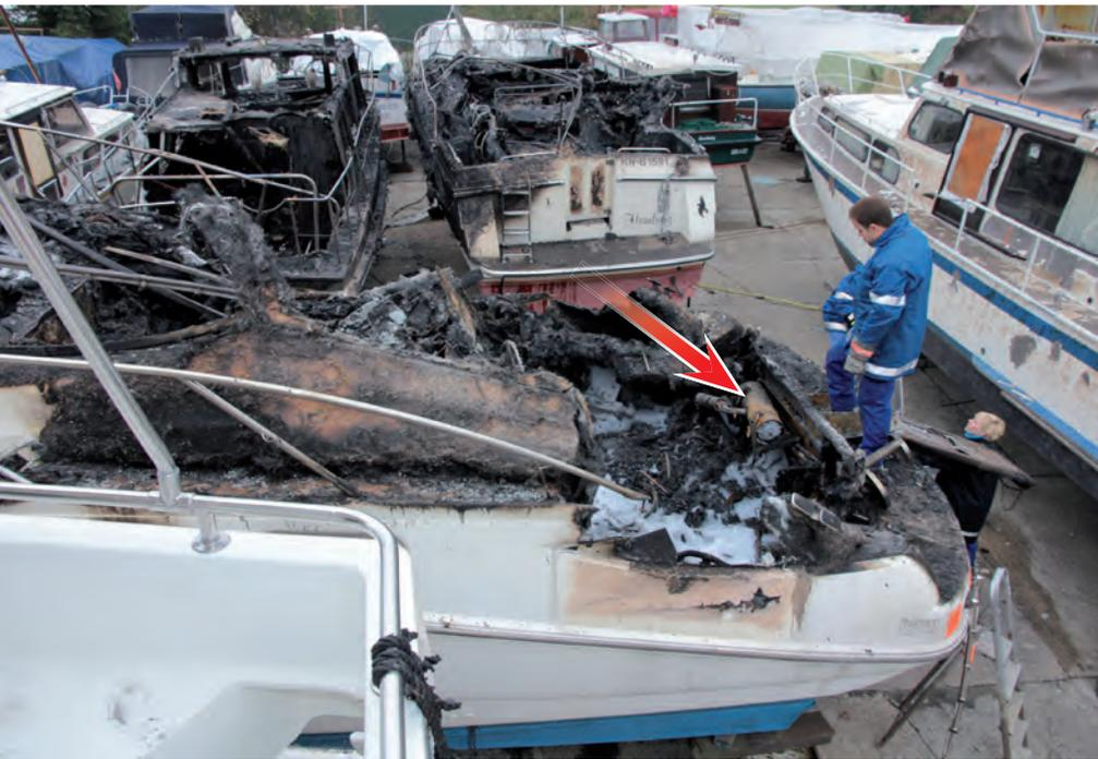
**Bild 1** | Brandschaden auf der Motoryacht: Der Pfeil markiert die Standheizung im Maschinenraum.
