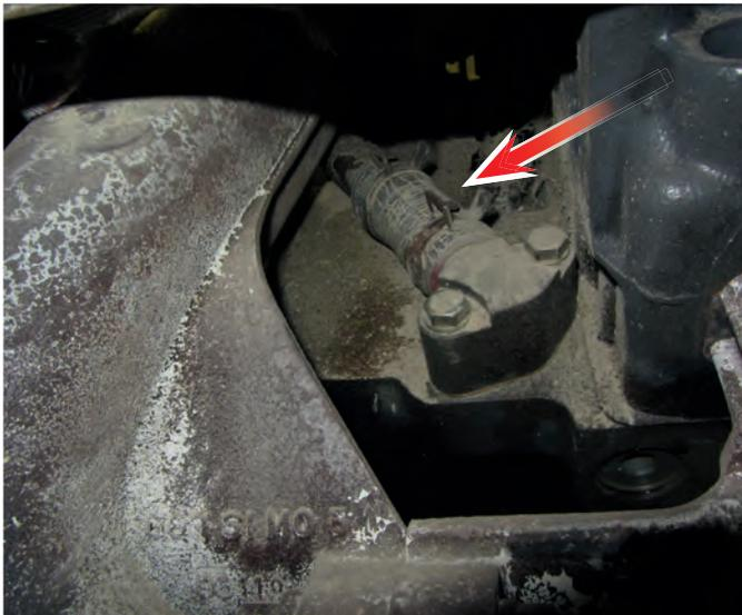
**Bild 3** | Schmierölrücklaufleitung an einem Turbolader ohne ausreichende Abschirmung
