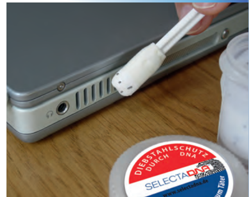
Bild 1 | Wertgegenstände wie Notebooks lassen sich daheim ganz einfach mit individueller künstlicher DNA und den ebenfalls in der Substanz enthaltenen Microdots markieren. Mitgelieferte Aufkleber warnen Langfinger vor dem erhöhten Tatbegehrungsrisiko.
