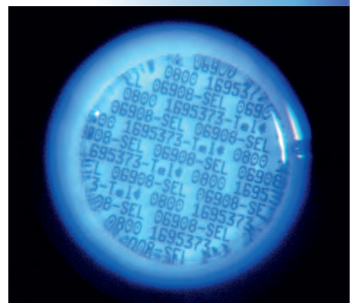
Bild 3 | Ein Microdot unter dem Mikroskop: So lassen sich die individuellen alphanumerischen Codes einfach ablesen.
