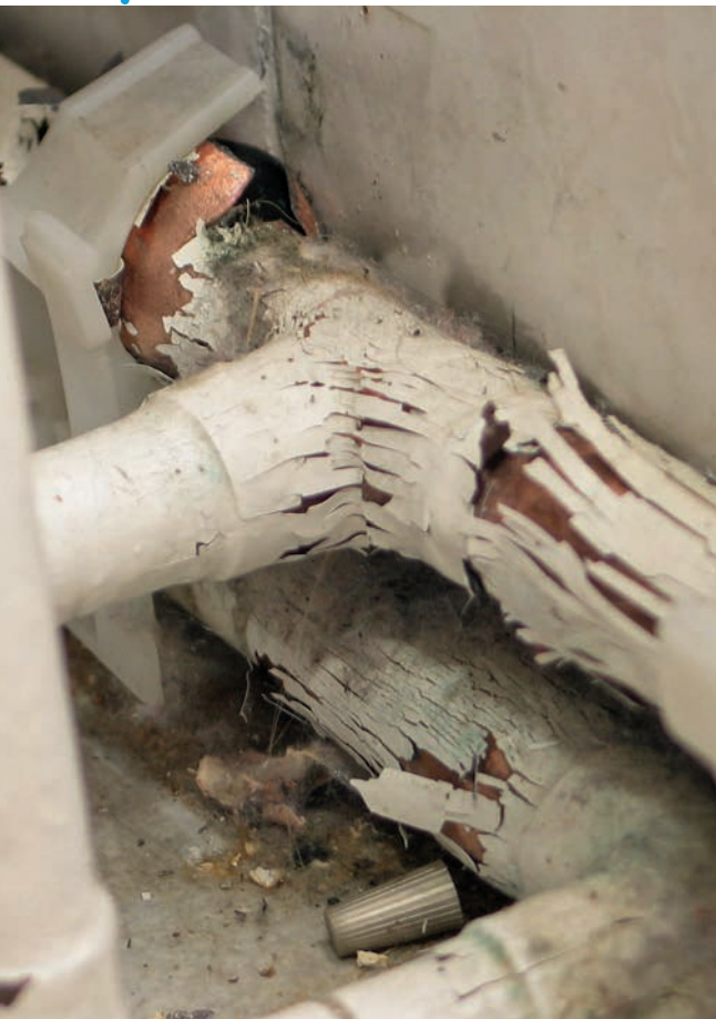
Bild 2 | Kupferrohre einer Heizungsinstallation, die infolge einer Frosteinwirkung plastisch verformt wurden und lokal geplatzt sind.
