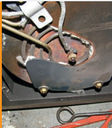
Bild 9 | Blick auf den Boden des Brenntopfes mit dem spiralförmigen Heizelement und dem in der Bodenmitte angeschraubten „Thermofühler 1“.
