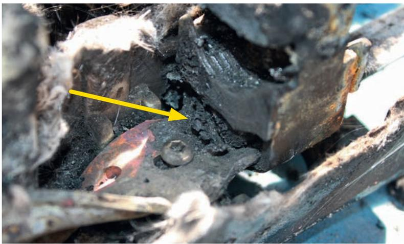
... geführt worden und es wurde zudem ein Teil der Aderisolation mit untergeklammt. Das weiche Isolationsmaterial begann infolge des Anpressdruckes und der Erwärmung bei Stromfluss zu fließen, sodass schlussendlich eine lose Klemmverbindung vorlag.
