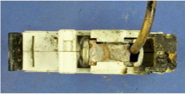
... ein Fehler bei Verdrahtungsarbeiten. Konkret war eine Leitungsader der Wohnungszuleitung nicht wie hier abgebildet in den Zugbügel der Anschlussklemme eines Leitungsschutzschalters, sondern ...
