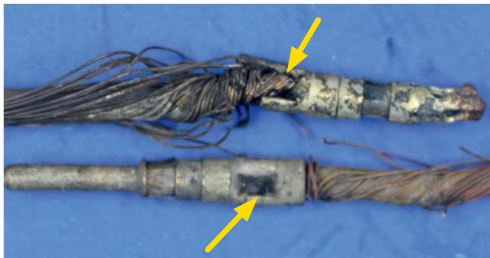
**Beispiel 9** | Fehlerhafte Crimpverbindungen an Gleichspannungsleitungen einer Photovoltaikanlage: Die Leiterquerschnitte sind für die verwendeten Verbindungselemente zu groß. Weiterhin wurde mit dem falschen Werkzeug gepresst bzw. gecrimpt, sodass die Verbindungselemente beschädigt wurden (Pfeile).
