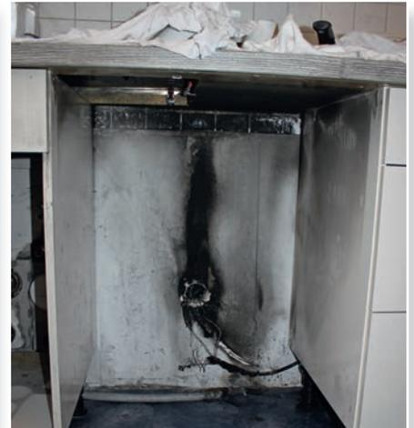
**Beispiel 2** | Kleiner Brandschaden im Bereich eines Elektroherdanschlusses – Ursache: Verwendung einer Drahtbrücke ...
