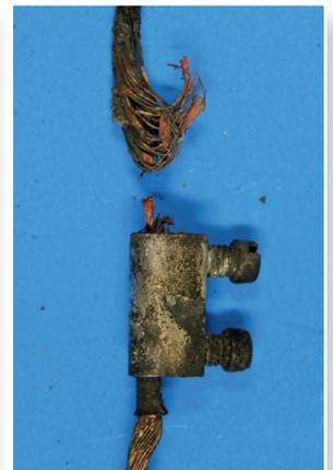
... an einer Anschlussklemme wurde nicht mit dem nötigen Drehmoment angezogen.
