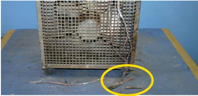
...der 32A-CEE-Anschlusssteckverbindung (Ellipse) eines zum Schadenzeitpunkt in Betrieb befindlichen Elektroheizers.
