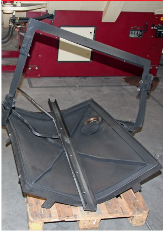
Bild 2 | Die Tür zur Vorkammer wurde durch die Druckwelle deformiert.
