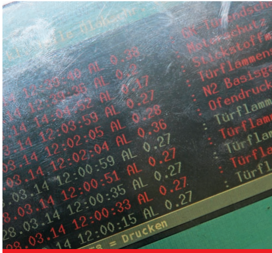
Bild 3 | Das Protokoll auf dem Display zeigt die Fehlermeldungen (rot) und deren Bestätigungen durch den Mitarbeiter (weiß).
