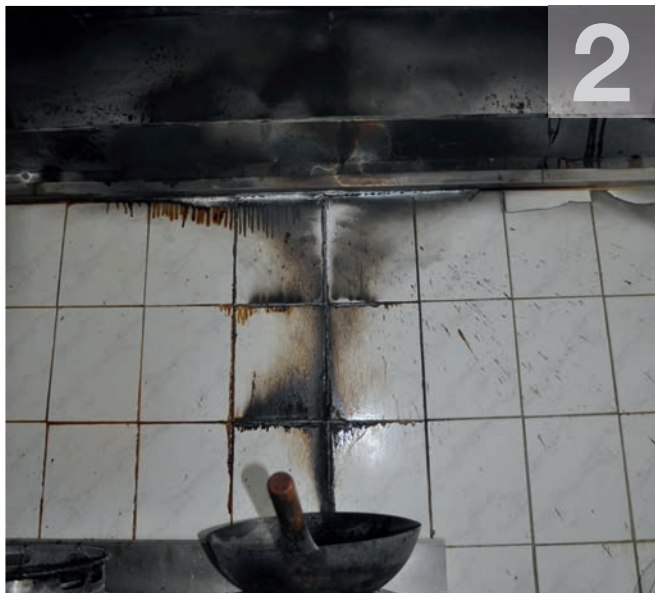
Bild 2 | Der Wok hatte auch zum Schadenzeitpunkt auf der Kochstelle gestanden. Dahinter zeichnet sich ein Brandtrichter an der Wand ab.
