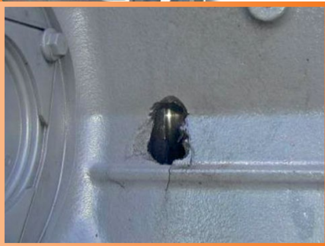
Bild 2 | Motorschaden infolge Pleuelabriss
