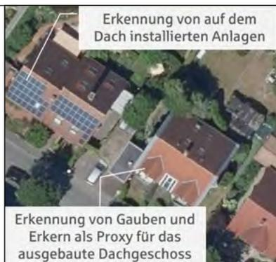
**Bild 2 /** Orthophotos zur Ableitung der PV-Anlage und des Dachgeschossausbaus
