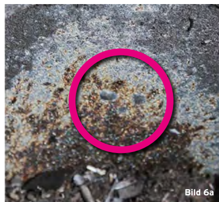
Bilder 6a und 6b / Über drei kleine Öffnungen würde hier im Falle eines Rückbrandes Wasser in die Austragung eingebracht. Im vorliegenden Fall waren diese aber derart verstopft ( Bild 6a ), dass das Löschwasser nicht in die Austragung eindringen konnte. Erst nach einer intensiven Reinigung durch den Brandursachenermittler ( Bild 6b ) kamen die Öffnungen wieder deutlich zum Vorschein.
