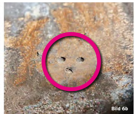
Bilder 6a und 6b / Über drei kleine Öffnungen würde hier im Falle eines Rückbrandes Wasser in die Austragung eingebracht. Im vorliegenden Fall waren diese aber derart verstopft ( Bild 6a ), dass das Löschwasser nicht in die Austragung eindringen konnte. Erst nach einer intensiven Reinigung durch den Brandursachenermittler ( Bild 6b ) kamen die Öffnungen wieder deutlich zum Vorschein.
