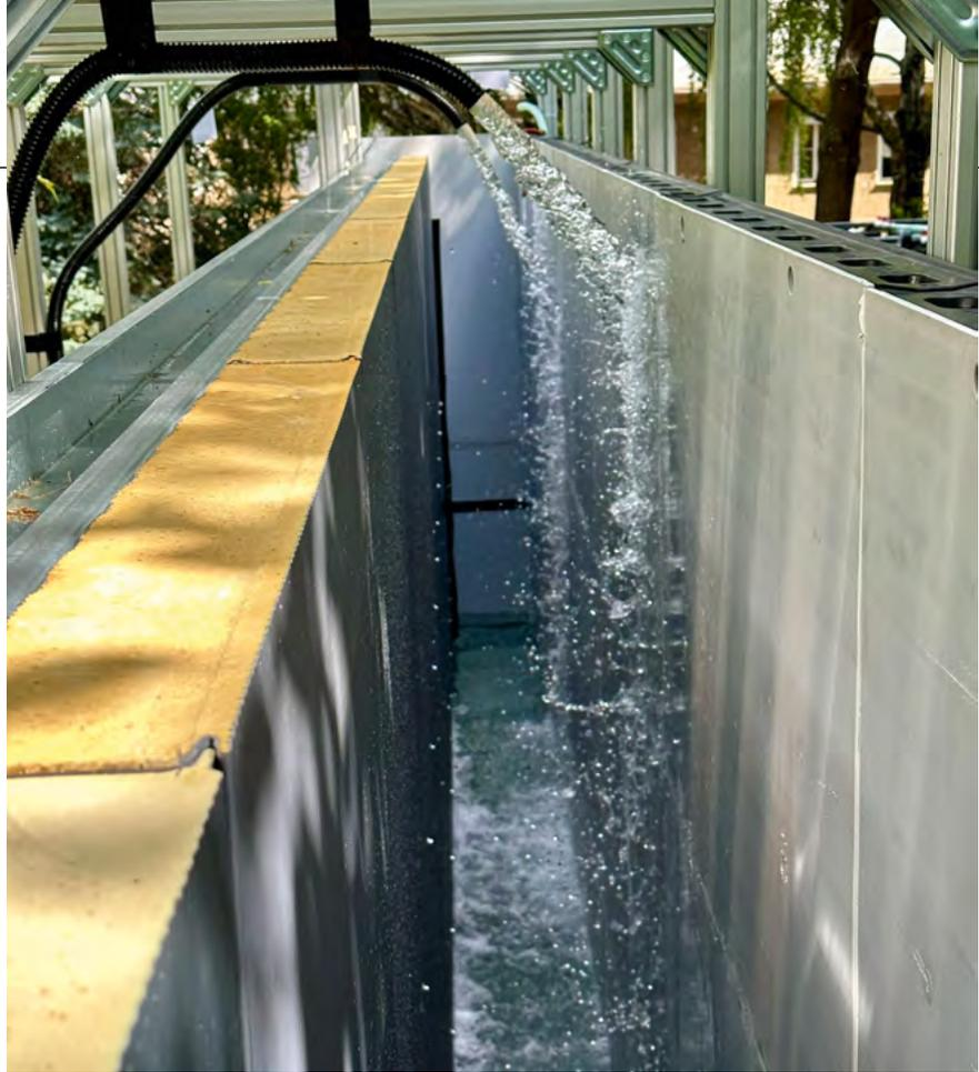
**Bild 2 /** Prüfung der Verformung und der Wasserdurchlässigkeit von Stahl-Sandwichkonstruktionen mit Dämmstoffkern aus Polyurethan-Hartschaum bei hydrostatischer Beanspruchung
