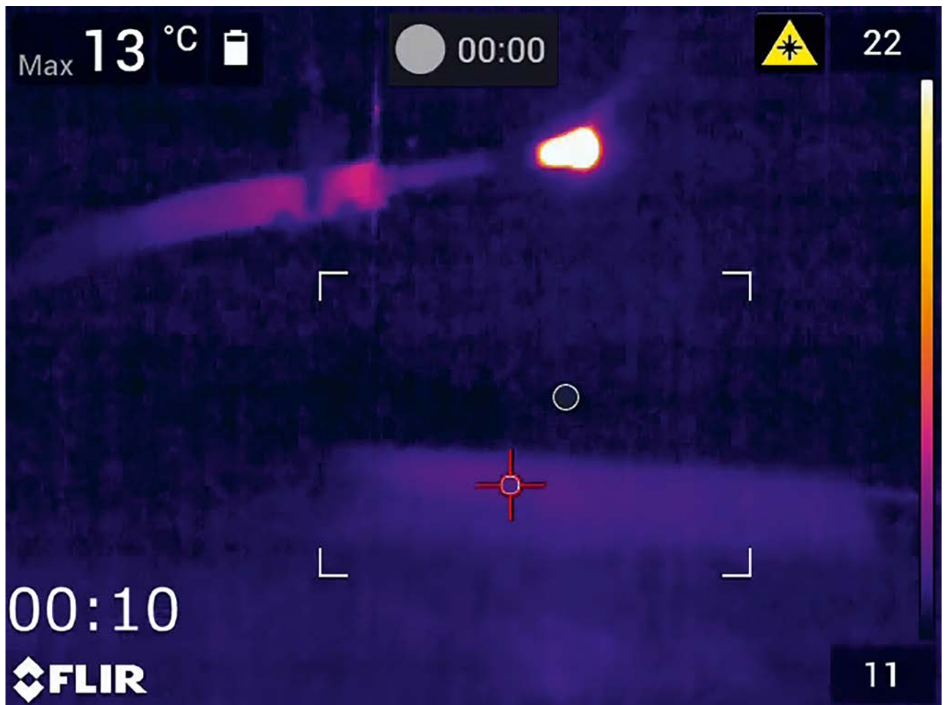
Bild 17 / Ausschnitt der Aufzeichnung nach dem Anzünden einer industriell hergestellten Zigarette. Unten links steht die Brenndauer der Zigarette. Der Messbereich der Wärmebildkamera wird so eingestellt, dass nur die Temperaturen der abfallenden Asche aufgezeichnet werden (weißes Viereck). Zusätzlich wird der Messmodus „Hotspot“ gewählt, sodass die Ascheglut mit der höchsten Temperatur im weißen Viereck erfasst wird.
