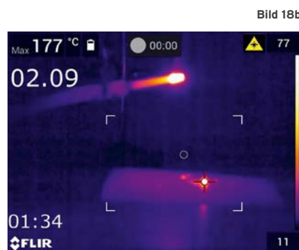
Bilder 18 a bis c / Ausschnitte der Wärmebildkameraaufzeichnung eines Abaschvorgangs einer industriell hergestellten Zigarette: Oben links wird die höchste Temperatur der abgefallenen Ascheglut angezeigt und darunter die Versuchsdauer nach dem Abaschen. Nach 0,5 Sekunden (a), nach zwei Sekunden (b) und nach fünf Sekunden (c) betragen die Temperaturen der Ascheglut 405 °C, 177 °C und 79 °C.
