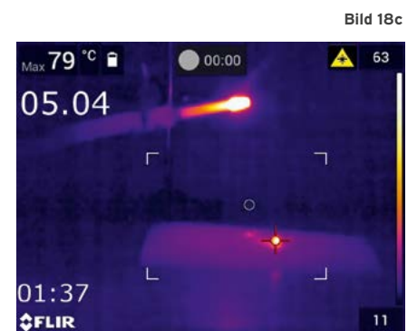
Bilder 18 a bis c / Ausschnitte der Wärmebildkameraaufzeichnung eines Abaschvorgangs einer industriell hergestellten Zigarette: Oben links wird die höchste Temperatur der abgefallenen Ascheglut angezeigt und darunter die Versuchsdauer nach dem Abaschen. Nach 0,5 Sekunden (a), nach zwei Sekunden (b) und nach fünf Sekunden (c) betragen die Temperaturen der Ascheglut 405 °C, 177 °C und 79 °C.
