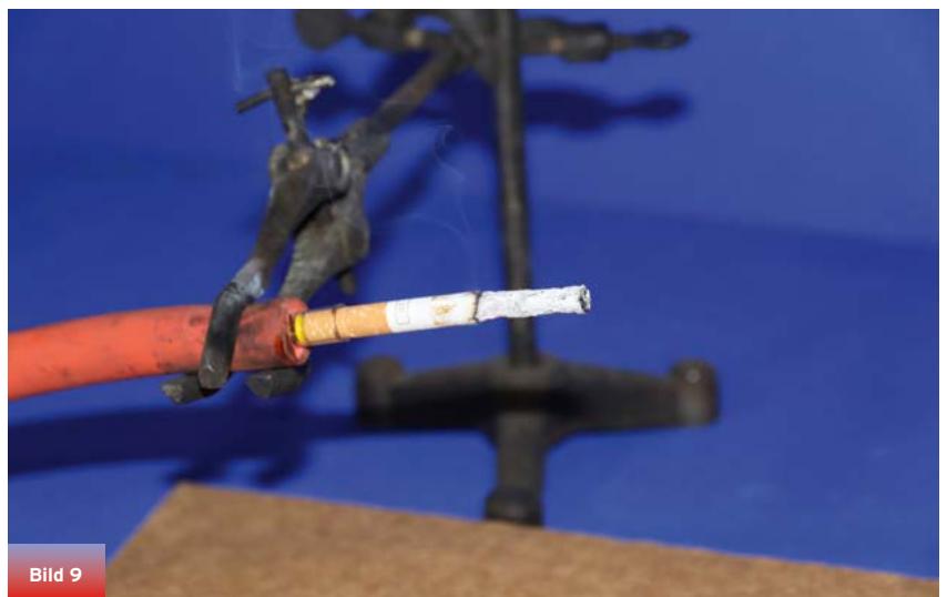
Bild 7 und 8 / Blick auf den Versuchsaufbau: Um möglichst homogene Aschereste für die einzelnen Versuche zu generieren, werden in einem Stativ festgeklammerte Zigaretten über einen Vakuumschlauch an eine Mini-Vakuumpumpe angeschlossen und mit einem Feuerzeug entzündet.
