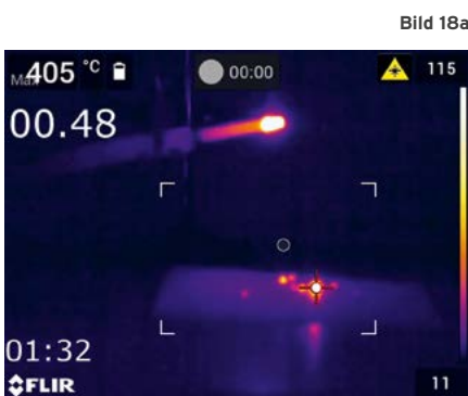
Bilder 18 a bis c / Ausschnitte der Wärmebildkameraaufzeichnung eines Abaschvorgangs einer industriell hergestellten Zigarette: Oben links wird die höchste Temperatur der abgefallenen Ascheglut angezeigt und darunter die Versuchsdauer nach dem Abaschen. Nach 0,5 Sekunden (a), nach zwei Sekunden (b) und nach fünf Sekunden (c) betragen die Temperaturen der Ascheglut 405 °C, 177 °C und 79 °C.
