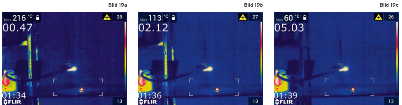
Bilder 19a bis c / Ausschnitte der Wärmebildkameraaufzeichnung eines Abaschvorgangs einer selbstgedrehten Zigarette: Oben links wird die höchste Temperatur der abgefallenen Asche angezeigt und darunter die Versuchsdauer nach dem Abaschen. Nach 0,5 Sekunden (a), nach zwei Sekunden (b) und nach fünf Sekunden (c) betragen die Temperaturen der Ascheglut 216 °C, 113 °C und 60 °C.
