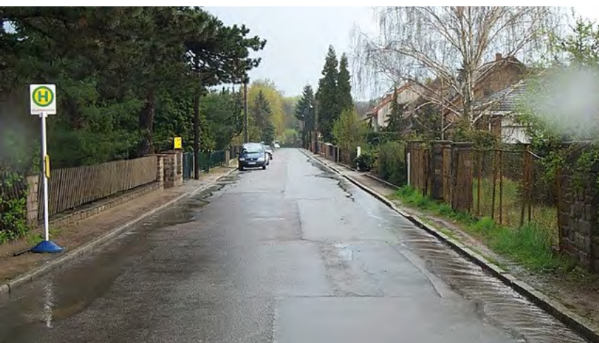
Bild 3 | Straßengestaltung im Dachprofil
