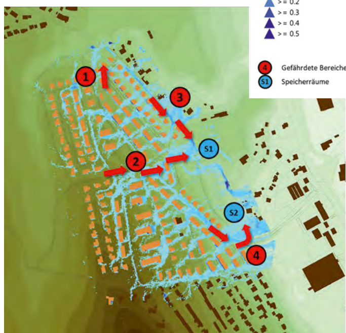
Grafik 7 | Modellierung von Fließbahnen im Baugebiet Halde-Nord in Kempten; Quelle: Ingenieurgesellschaft Prof. Dr. Sieker mbH
