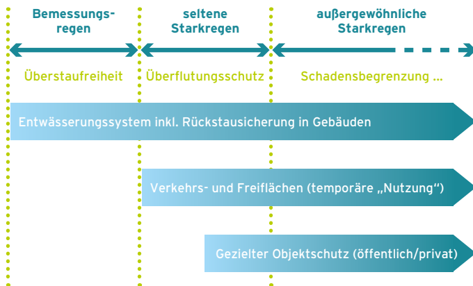
Grafik 6 | Überflutungsschutz und Überflutungsvorsorge nach DWA-Merkblatt; Quelle: Ingenieurgesellschaft Prof. Dr. Sieker mbH in Anlehnung an DWA-M 119
