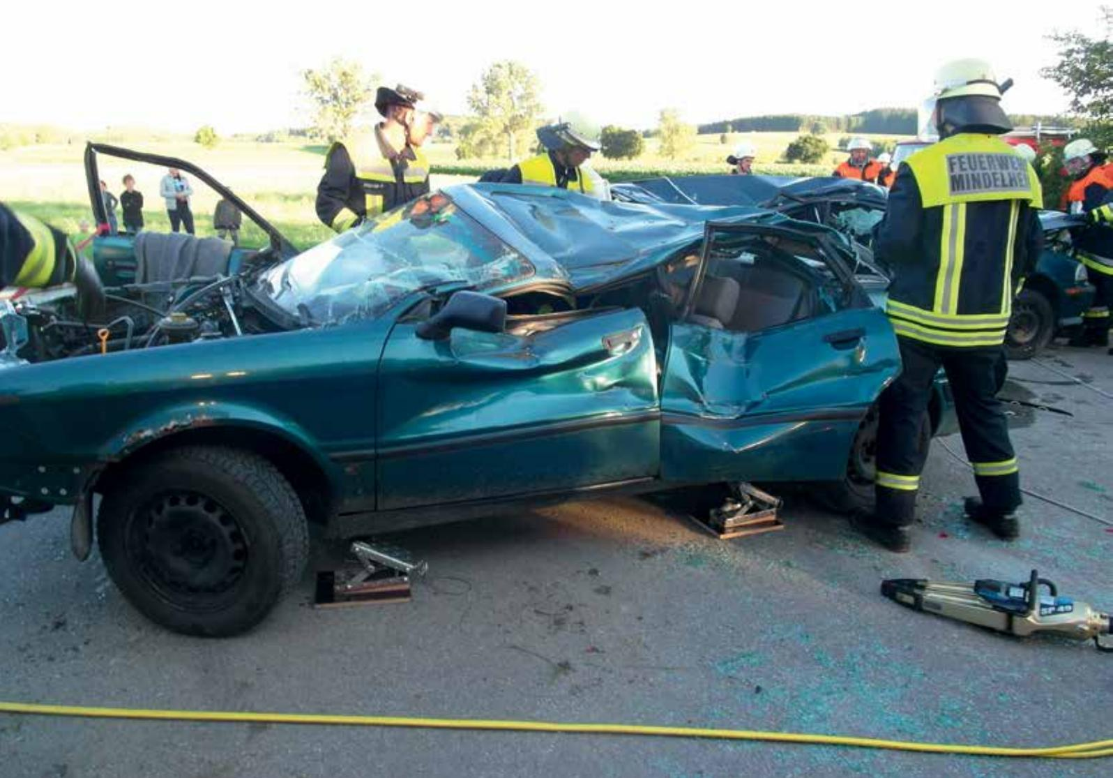
Diese Übung zeigt: Wenn eine Person in einem derart schwer eingedrückten Fahrzeug eingeklemmt wäre, würde jede Sekunde zählen. Kostbare Zeit spart hier das Schnell-Unterbausystem.
