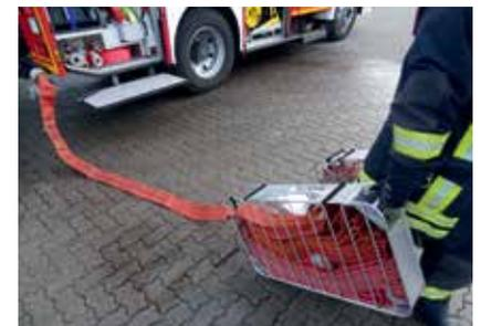
Der Transport von zwei Körben gleichzeitig (80 m Schlauch) ist problemlos möglich.
