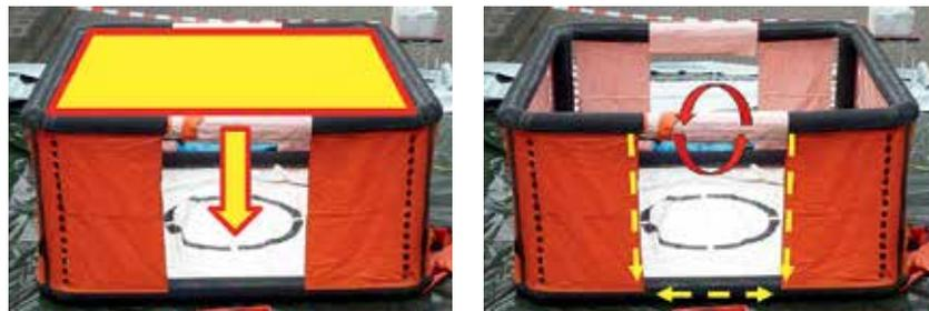
**Bild 4 und 5** | Die Grundkonstruktion konnten die Feuerwehrleute aus dem vorhandenen Material des Sprungretters herstellen.
