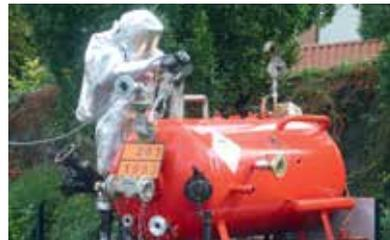
Auch mit der zweiten, kleineren Übungsanlage kann die Werler Feuerwehr Gefahrgutunfälle, Unfälle im Chemiebetrieb, Menschenrettungen aus Tanks, Tanklastzug- und Kesselwagenunfälle sowie die Gasbrandbekämpfung realistisch darstellen.
