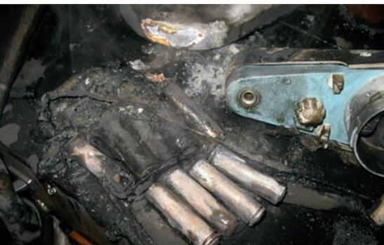
**Bild 24** | Brandschaden an einem E-Bike.
