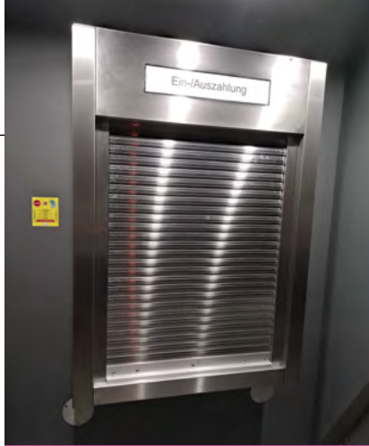
Bild 3 / Rolladen am Bedienkopf eines Geldautomaten außerhalb der Betriebszeit
