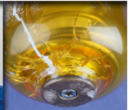
**Bild 5** | Risse in der Filtertasse eines Feinfilters können bei einer Wartung entdeckt werden. Durch rechtzeitiges Wechseln der Tasse kann ein Leitungswasserschaden verhindert werden.
