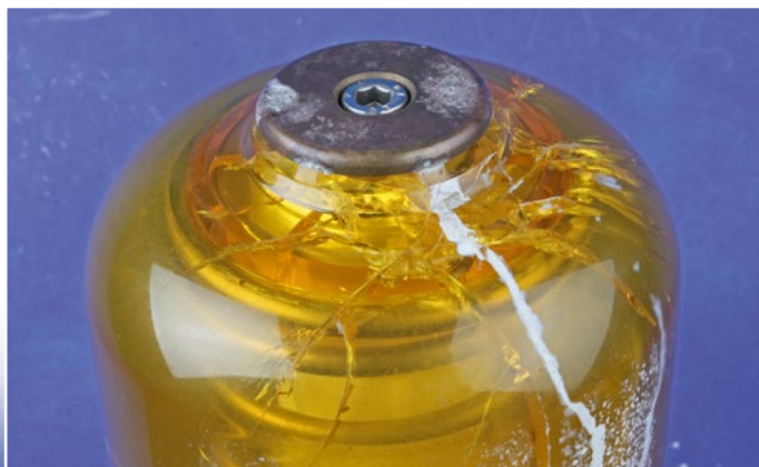
Bild 5 | Zu hohe mechanische Beanspruchung führte zur Zerstörung dieser Filtertasse.
