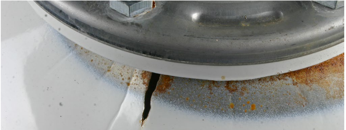
Bild 7 | Detail des schadenursächlichen Ausdehnungsgefäßes: Direkt an der Ventilkappe sind ein Riss und Korrosionsspuren zu erkennen.
