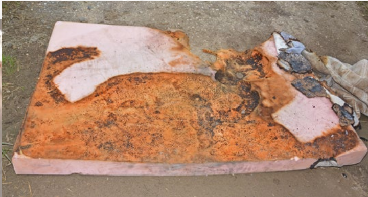
Bild 2 | An der Stelle, an der das Telefon gelegen hatte, ist die Matratze verbrannt.
