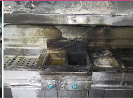
Bild 4 | Brandgeschädigte Fritteuse
