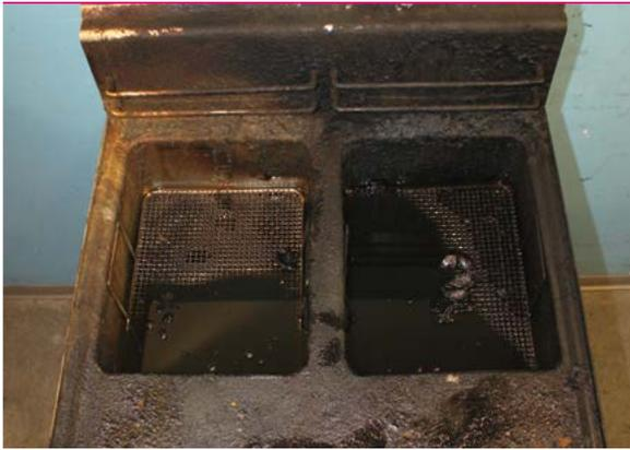
Bild 5 | Ausgebaute brandgeschädigte Fritteuse
