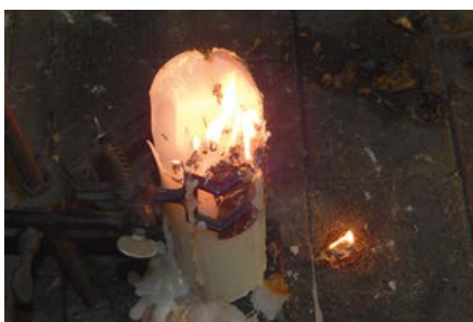
Bild 2 | Bei der Kerze wurde ein fackelartiger Abbrand festgestellt. Die baugleiche Kerze führte kurz zuvor zu einem Brandschaden in der Nachbargemeinde. In der Abbrandzone der zur Verfügung gestellten Kerze sind die nicht brennbaren Folienreste der Wachsdekorplatte vorhanden. Diese können unter ungünstigen Umständen als weiterer Docht wirken. Das Auftreten von mehreren Flammen in einer Kerze kann zum Wachsvollbrand führen. In diesem Fall tropfen die Dekorelemente brennend ab.
