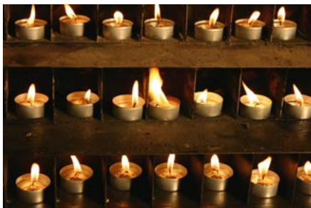
Bild 1 | Im Laborversuch wird ein Wachsvollbrand bei einem Teelicht (Bildmitte) beobachtet, das zu dicht neben und über anderen Teelichtern platziert war.
