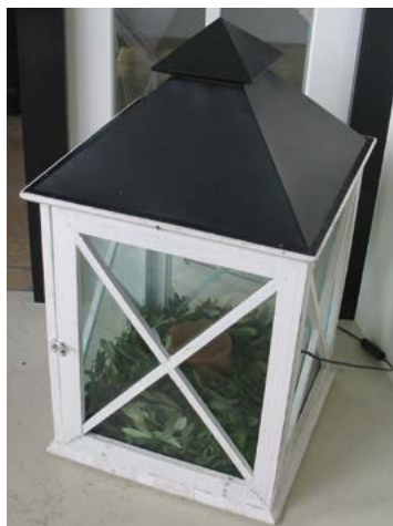
Bild 6 | Eine derartige Laterne war im Fußpunkt des Brandtrichters ( Bild 5 ) aufgestellt gewesen. Die Kombination von Kerze und dekorativem Grün aus Kunststoff gleicht dabei fast schon einem Brandsatz – Kerzen sollten nie in einer brennbaren Umgebung aufgestellt werden.
