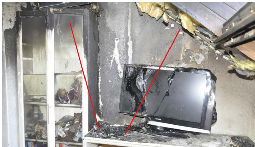
Bild 3 | Auf einem Sideboard kam es neben einem Fernseher zu einem Brand. Der Brandtrichter fußt auf dem Sideboard neben dem Fernseher (rote Striche). Dort ...
