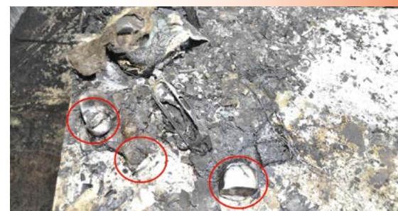
Bild 4 | ... werden Teelichtbecher (rote Markierungen) gefunden. Andere Zündquellen waren dort nicht vorhanden. Der Brand ist auf die dort auf einem brennbaren Untergrund und zudem sehr nahe an einem Fernseher abgestellten Teelichter zurückzuführen.
