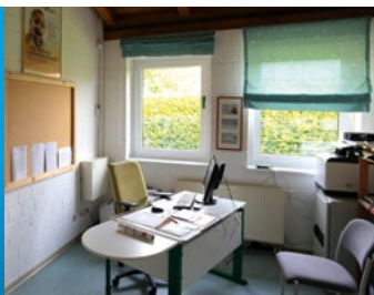
Bild 4 | Risikoklasse 0 In diesem Büroraum sind keine Trinkwasserleitungen oder Armaturen vorhanden. Das Risiko eines Leitungswasserschadens ist hier sehr gering. Ein Restrisiko ist jedoch durch die Heizungsinstallation gegeben.
