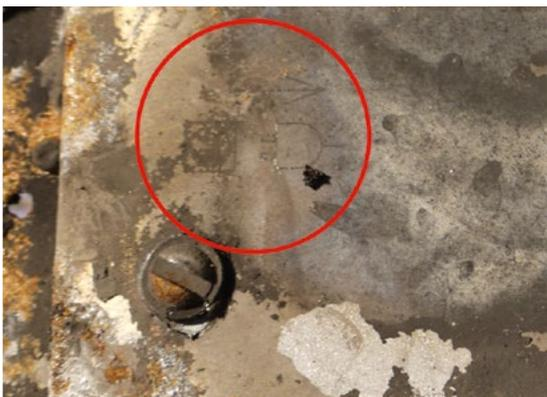
**Bild 11** | Das Piktogramm (rote Markierung) besagt, dass der Netzstecker gezogen werden soll. Es ist sogar noch nach dem Brand zu erkennen.
