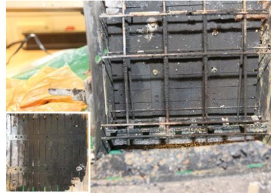
**Bild 9** | Als Vergleich ist hier ein Toaster gezeigt, durch den kein Brand nach dem zuvor beschriebenen Mechanismus ausgelöst wurde. Das kleine Bild unten links zeigt die herausgetrennte Heizwendel in der Ausrichtung wie in den **Bildern 2 und 4**. Diese Heizwendel ist im Gegensatz zu den Heizwendeln in den **Bildern 2 und 4** stark mit Ruß beaufschlagt.
