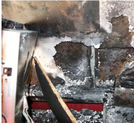
**Bild 8** | Der brandgezehrte Toaster hat sich auf dem links am Bildrand zu erkennenden – nach der Untersuchung durch die Kriminalpolizei senkrecht stehenden – Glaskeramikherd befunden.
