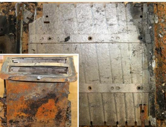
**Bild 4** | Auch dieser Toaster zeigt nur minimale Rußbeaufschlagungen auf den Heizwendeln, während direkt daneben liegende Bereiche, die im Betrieb nicht heiß werden, stark mit Ruß beaufschlagt sind. Eingefügtes Bild unten links: der Toaster vor der Demontage.
