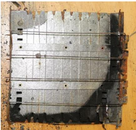
**Bild 2** | Eine der drei Heizwendeln. Diese sind beinahe frei von Rußbeaufschlagungen.
