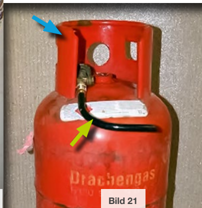
Bild 21 | Treibgasflasche mit Kragen (blauer Pfeil) und (demontiertem) Steigrohr (grüner Pfeil)
