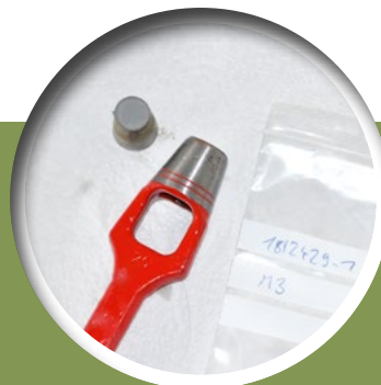
Henkellocheisen mit Stopfen zur Probenahme von Putzproben
