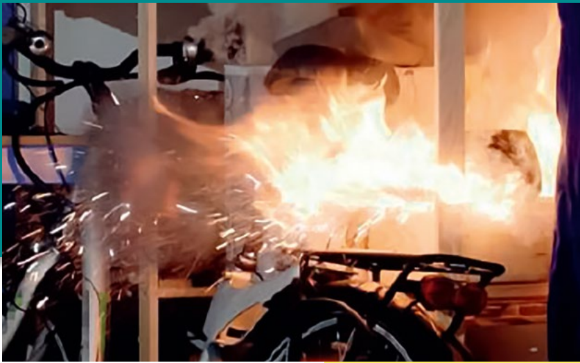
Bild 3 | Explosion eines E-Bike-Akkus (Quelle: IFS Report, 22. Jahrgang, März 2019)
