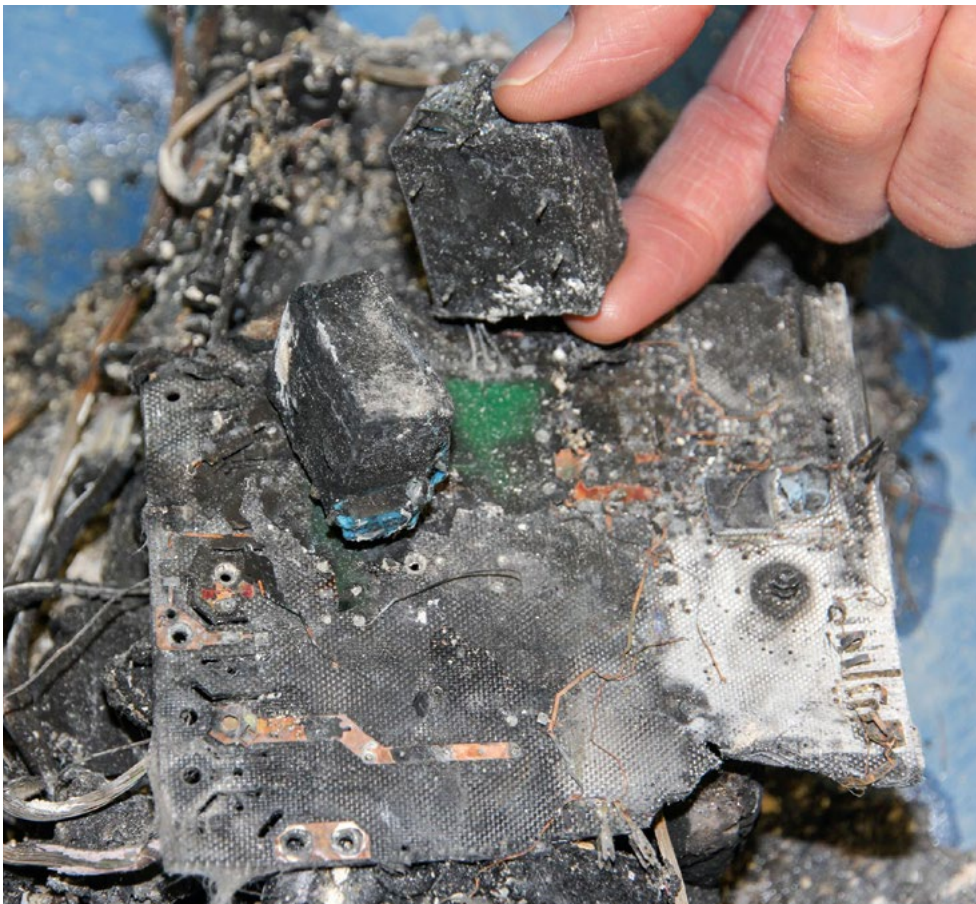
Bild 3 | Die Hauptplatte des Durchlauferhitzers wird im IFS untersucht.
