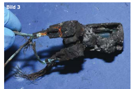
Bild 2 / Ansicht der rechten Seite des Wäschetrockners mit demotierter Seitenwand Bild 3 / Darstellung der Überreste des brandursächlichen Motorkondensators
