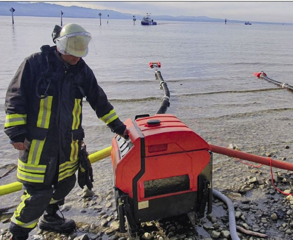
Bild 1 / Einsatz von Schwimmsaugern im Bodensee beim Brand einer Werft Bild 2 / Schwimmsauger im Einsatz bei niedriger Wasserhöhe
