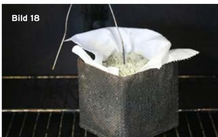
**Bild 18** / Auf Kieselgur aufgetragenes Öl in einem mit einem Tuch ausgekleideten Drahtkorb
