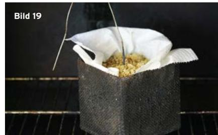
**Bild 19** / Das Probematerial verfärbt sich während der Versuche braun bis schwarz.
