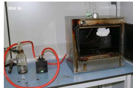
**Bild 16** / Die zu untersuchende Probe befindet sich in dem Ofen und ist mit einem Temperaturfühler versehen. **Bild 17** / Schematische Darstellung der Messapparatur zur Untersuchung des Selbstentzündungsverhaltens
