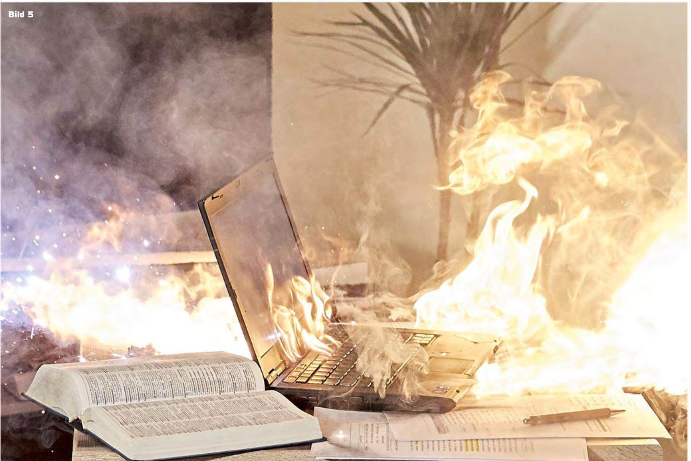
**Bild 5 /** Technische Mängel, beispielsweise aufgrund von Produktionsfehlern, oder ein unsachgemäßer Umgang können zu Defekten führen. Die im Akku gespeicherte Energie kann dann unkontrolliert in Form von Hitze freigesetzt werden. Dieser sich selbst verstärkende Prozess wird auch als „thermisches Durchgehen“ („thermal runaway“) bezeichnet.
