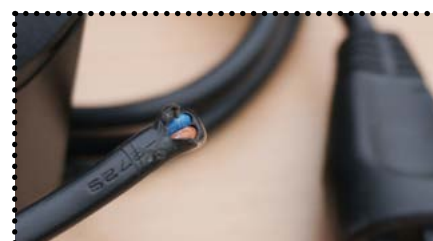
Bild 3 / Beschädigte Anschlussleitung eines Ladegeräts
