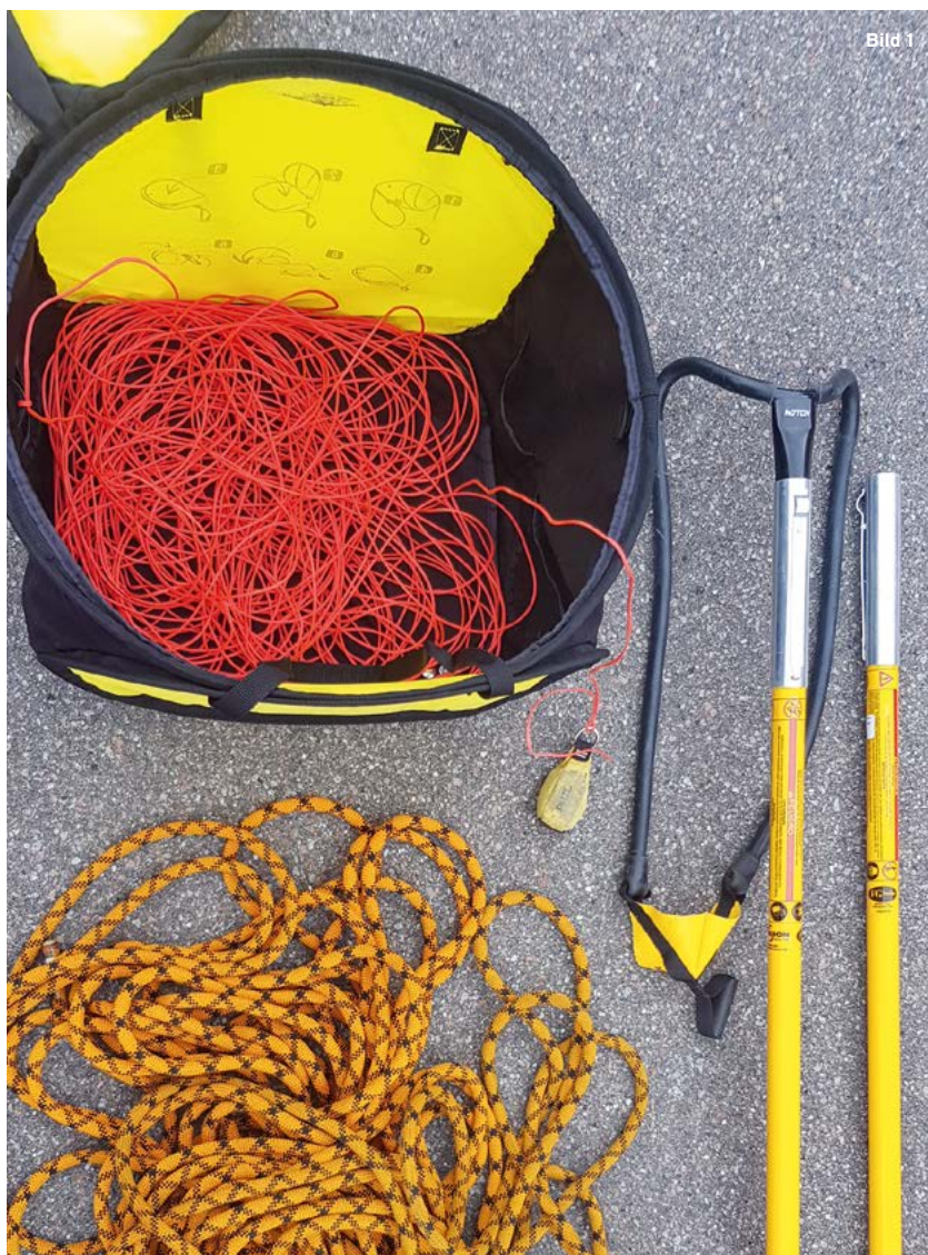
Bild 1 / Seilschleuder, Wurfleine und Fixierseil sind unter anderem für den Aufbau notwendig.
