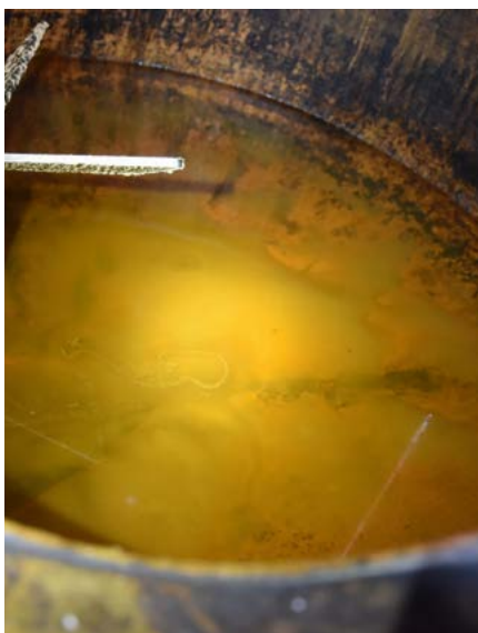
Bild 3 / In der Brennblase befindet sich eine Flüssigkeit mit fast 50 Vol.-% Alkohol.
