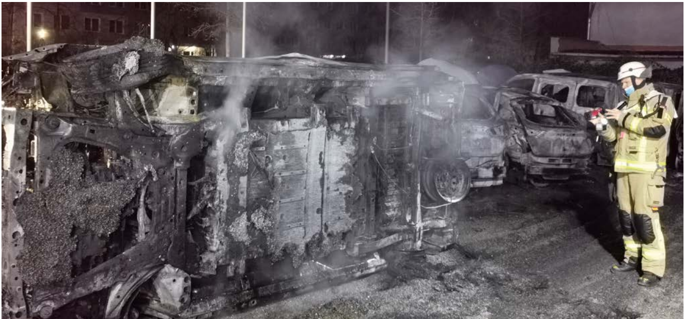
Bild 10 / Bei einem Brand einer Vielzahl von PKW und Kleintransportern auf einem Werkstattgelände kam es zum längeren intensiven Brand dieses Elektro-Transporters. Zur einfachen vorsorglichen Kühlung und Temperaturkontrolle der Hochvoltbatterie wurde das Fahrzeug auf die Seite gekippt (Foto: Dr. Rolf Erbe).
