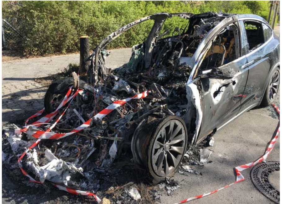
Bild 7 / Kommt es zum Brand eines Elektro-PKW, so trägt nach den Erfahrungen der Berliner Feuerwehr die Hochvoltbatterie kaum zum Brandgeschehen bei, sofern die Brandbekämpfung im Rahmen der innerörtlich üblichen Hilfsfrist von ungefähr 15 Minuten einsetzt. Da weniger Betriebsstoffe austreten als bei Bränden von Pkw mit konventionellem Antrieb ist der Aufwand zur Gefahrenabwehr häufig eher geringer als bei Bränden von Pkw mit Verbrennungsmotoren (Foto: Thomas Knauer).
