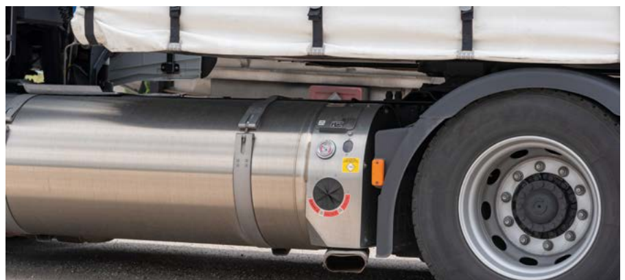
Bild 3 / Beispiel für einen LNG-Kraftstoffbehälter an einem LKW, in dem tiefkalt verflüssigtes Erdgas bei Temperaturen von ungefähr -162°C mitgeführt wird.
